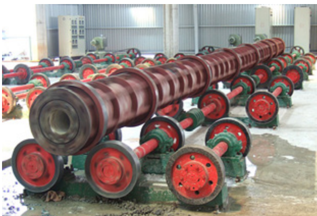
Dây chuyền sản xuất cọc ống ly tâm Spun Pile Production Line
