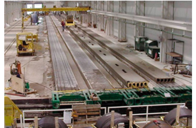
Dây chuyền sản xuất cọc / panel rỗng Hollow cored Panel / Pile Production Line
